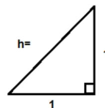
$$h^2 = c^2 + c^2 \dots \dots \text{Teorema de Pitágoras}$$
